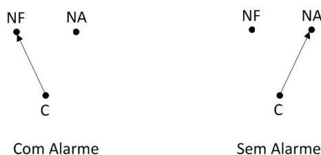
Figura 29 – Comportamento da saída de alarme (relé).
